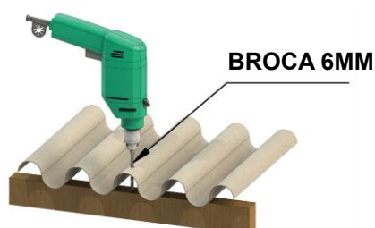
Figura 6 - Pré-furo na viga.
