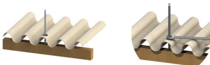
Figura 7 - Haste fixada na viga.
