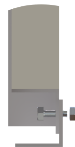
Montagem dos parafusos
