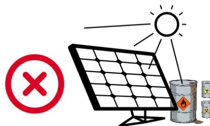
Figura 10 – Instalação em ambiente perigoso
