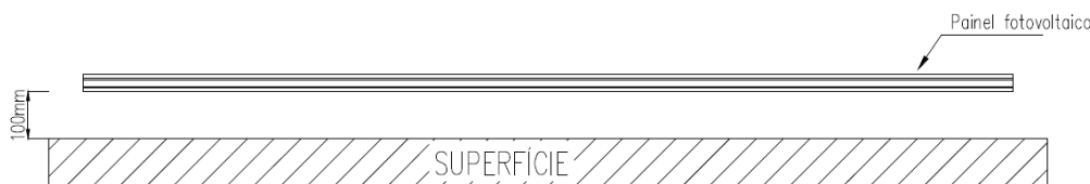
Figura 15 – Ambiente de instalação correto
